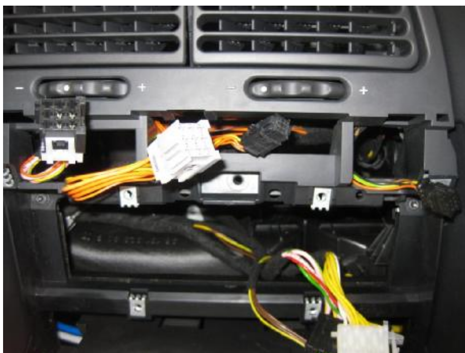
در این تصویر سوکتهای نوار میانی و سوکتهای (رادیو پخش مشاهده می شود) .
