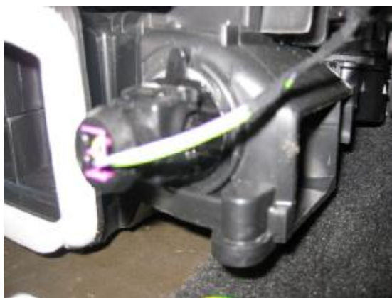
سنسور سنجش دمای هوای فروجی سیستم تهویه جهت تنظیم کولر اتوماتیک
